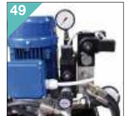
Un riduttore di pressione per morsa idraulica. One pressure reducer for hydraulic vice.
