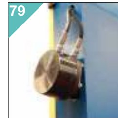
79 H601 - H700 - KS702 KTECH 702 Tensione idraulica del nastro. Hydraulic blade tension.
