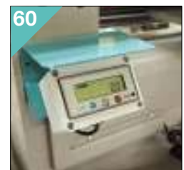
Visualizzazione angolo di taglio tramite display lcd. Angle digital display.
