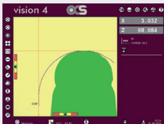
Summenbild, Wirkkonturerfassung an sich drehendem Werkzeug detects and measures the contour on a rotating tool
